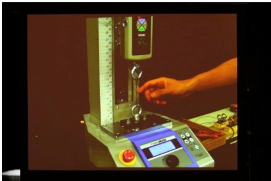
素材毎のピークを超える引っ張り力を加えて破断するまで検証。
