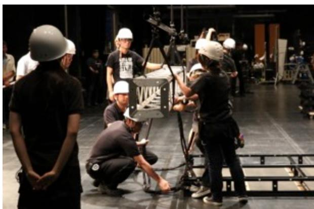
今回、様々な資材を使用して実験・検証をしたが、メーカーが記載している荷重に似た数値で破損したが、使用方法を間違えると強度は激減する。また、何度も使い回しすると経年劣化と疲労による破損もある。
